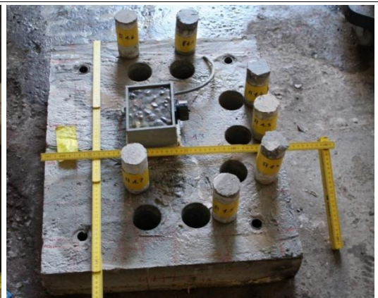
Lage der Bohrkern in Platte A1
