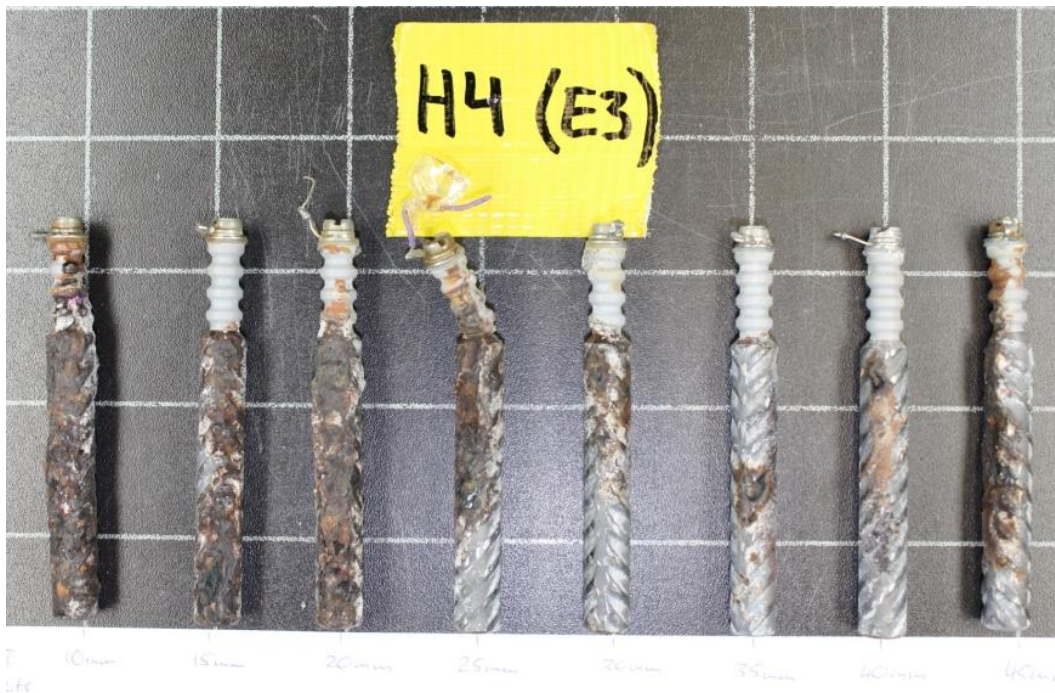
Abb. X-14 Korrosionszustand der Betonstähle nach dem Ausbau 2012 in der Betonplatte H4 (Typ A, Beton w/z 0.5). Bewehrungsüberdeckungen von 10 bis 45 mm (Stufen à 5 mm).
