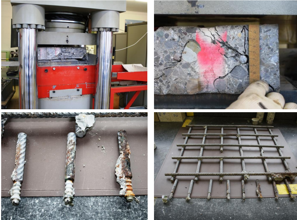
Abb.15 Bild links oben: Ausbau der Stahlproben mittels Druckpresse, Bild rechts oben: Druckversagen des Betons, Bild links unten: aus der Betonplatte herausgelöste, korrodierte Bewehrungsstäbe, Bild rechts unten: freigelegtes, rückseitiges Bewehrungsnetz.
