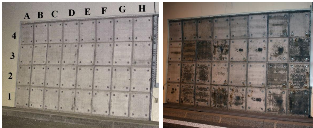
Abb. 2 Versuchsstand Naxbergtunnel. Bild links aus dem Jahr 2000, rechts von 2012.
