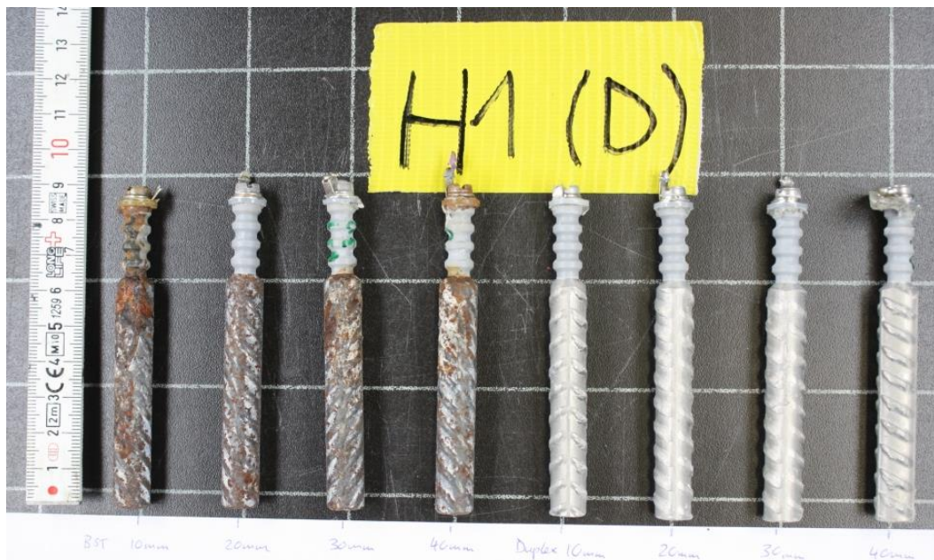
Abb. 35 Korrosionszustand der Betonstähle nach dem Ausbau 2012 in der Betonplatte H1 (Typ D). Von links nach rechts: 4 x Betonstahl (10/20/30/40 mm), 4 x Nichtrostender Betonstahl 1.4462 (10/20/30/40 mm).
