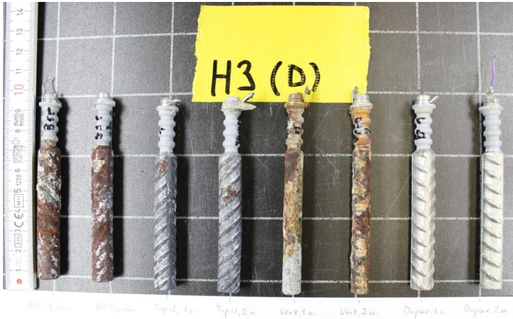
Abb. X-11 Korrosionszustand der Betonstähle nach dem Ausbau 2012 in der Betonplatte H3 (Typ D). Von links nach rechts: je 2 x Betonstahl oben/unten (10 mm), Top12, verzinkter Stahl, nichtrostender Stahl 1.4462.
