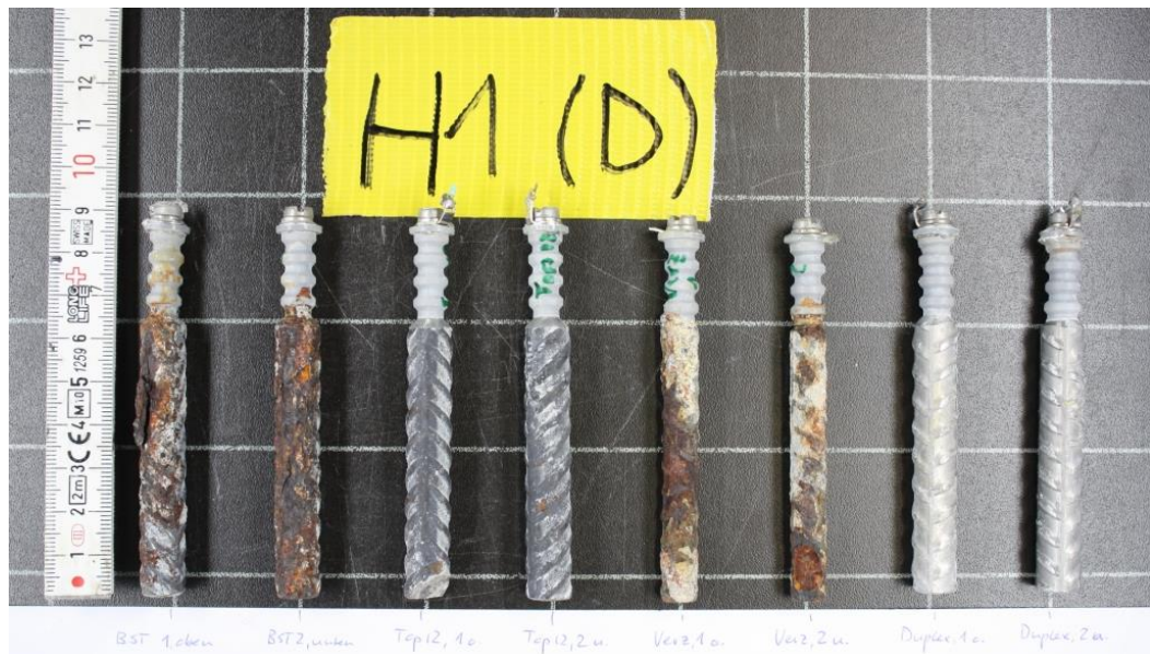
Abb. 37 Korrosionszustand der Betonstähle nach dem Ausbau 2012 in der Betonplatte H1 (Typ D). Von links nach rechts: 2 x Betonstahl oben/unten (10 mm), 2 x Top12 (10 mm), 2 x verzinkter Stahl (10 mm), 2 x nichtrostender Stahl 1.4462 (10 mm).
