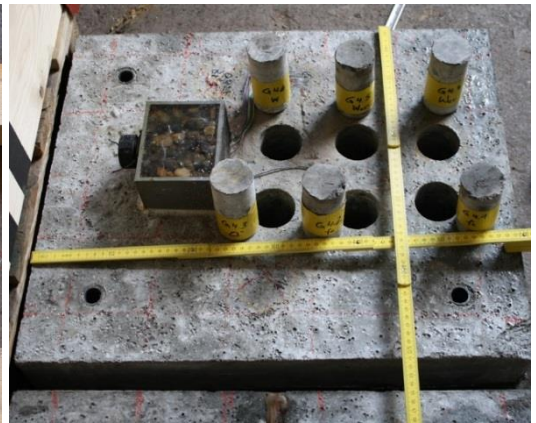
Lage der Bohrkern in Platte G4
