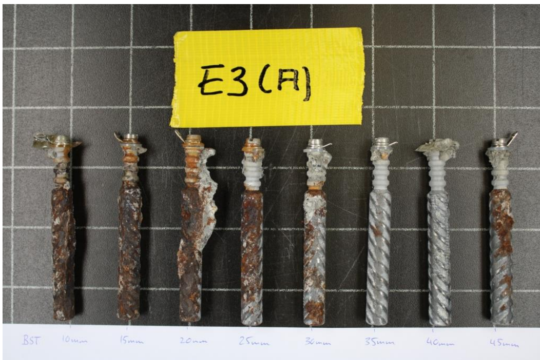
Abb. X-4 Korrosionszustand der Betonstähle nach dem Ausbau 2012 in der Betonplatte E3 (Typ A, Beton mit Flugasche). Bewehrungsüberdeckungen von 10 bis 45 mm (Stufen à 5 mm).
