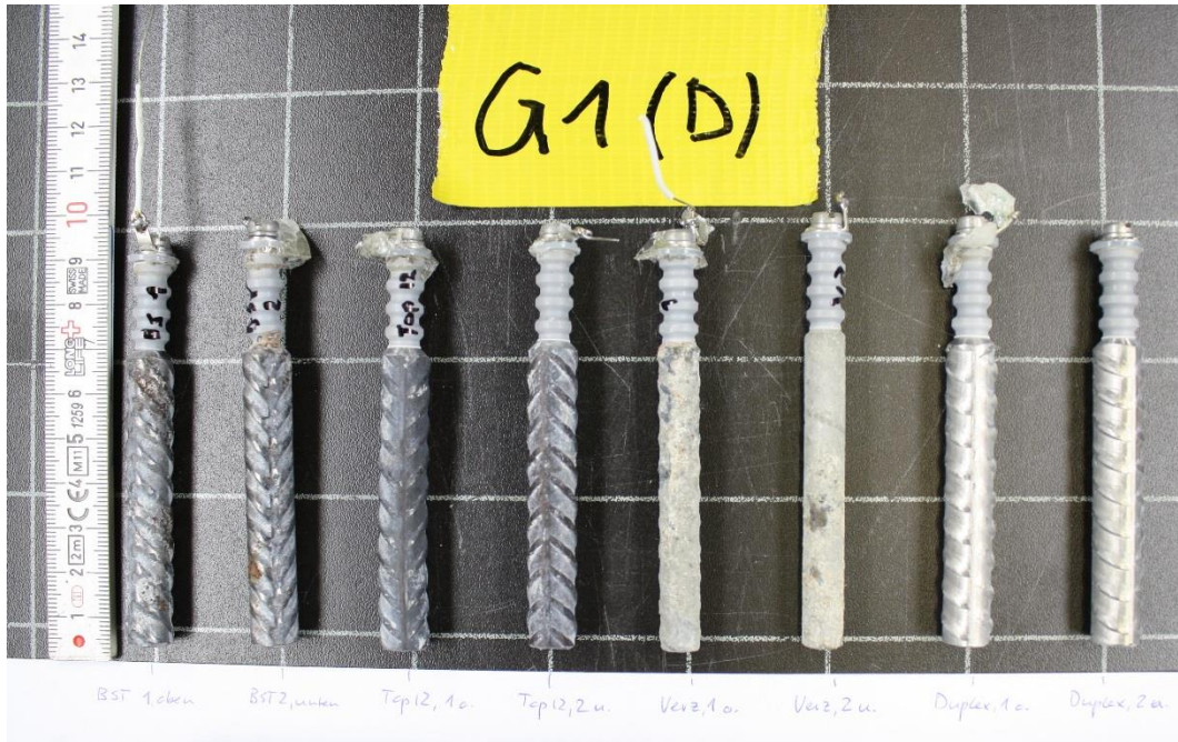
Abb. X-7 Korrosionszustand der Betonstähle nach dem Ausbau 2012 in der Betonplatte G1 (Typ D). Von links nach rechts: je 2 x Betonstahl oben/unten (10 mm), Top12, verzinkter Stahl, nichtrostender Stahl 1.4462.
