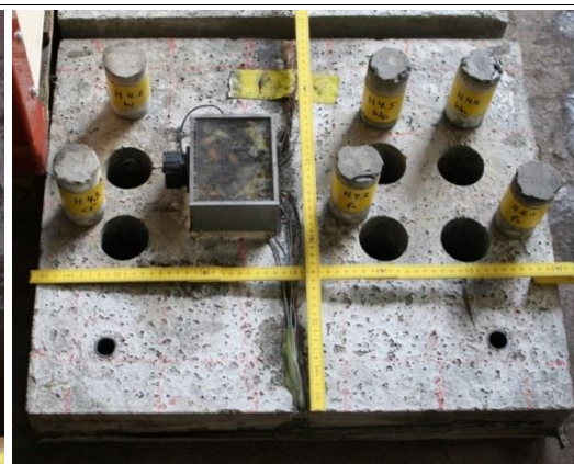
Lage der Bohrkern in Platte H4
