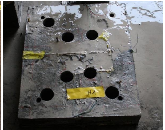
Lage der Bohrkern in Platte G1
